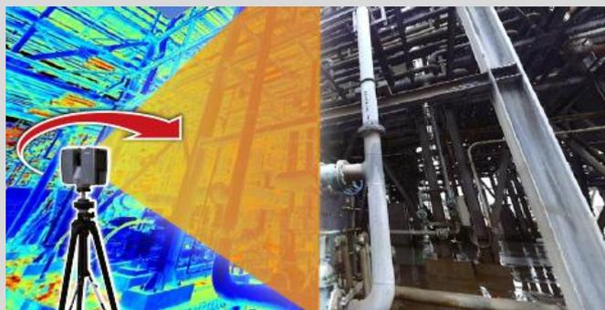
現地にて3Dレーザー計測を行い、点群データを作成します。
